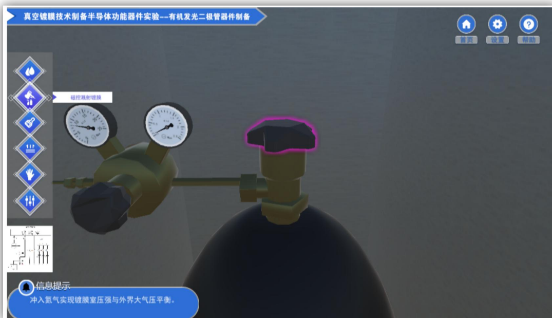
图 7 向腔内充入氮气的高压气瓶以及减压阀门
