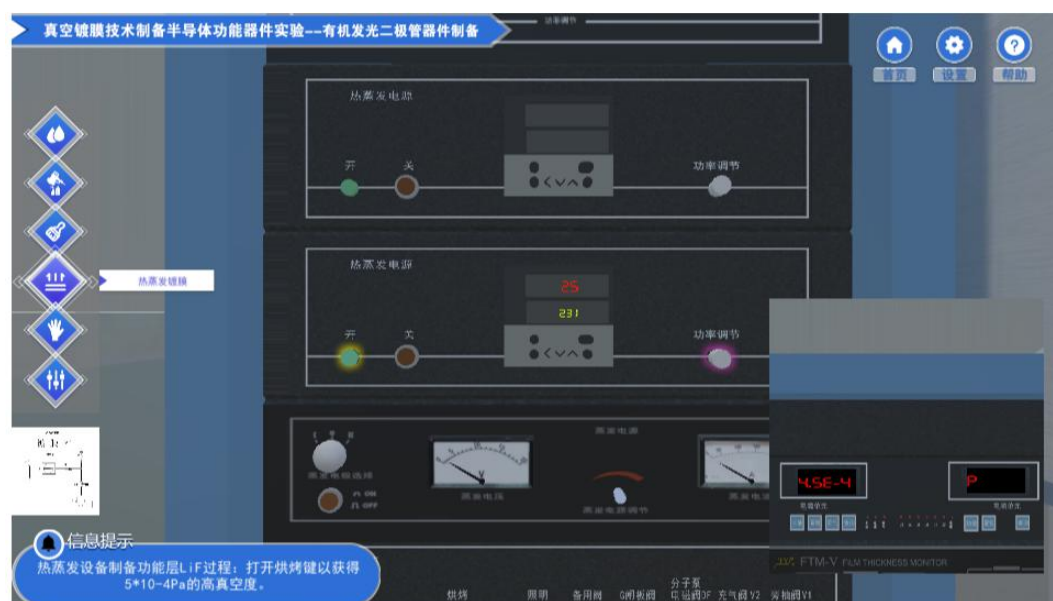
图 24 有机束源炉热蒸发有机功能层材料
