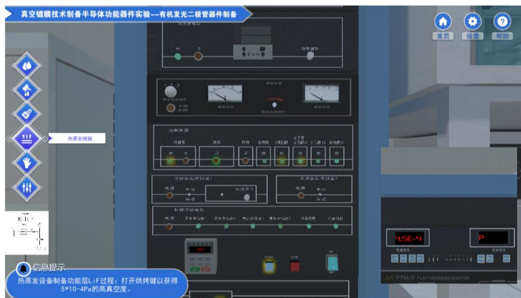
图 23 机械泵和分子泵联合获取高真空
