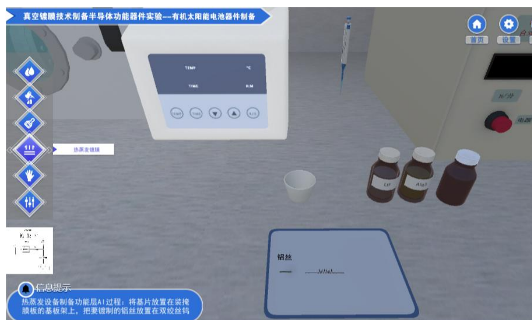
图 27 放置热蒸发电极材料、钨舟及掩模板
