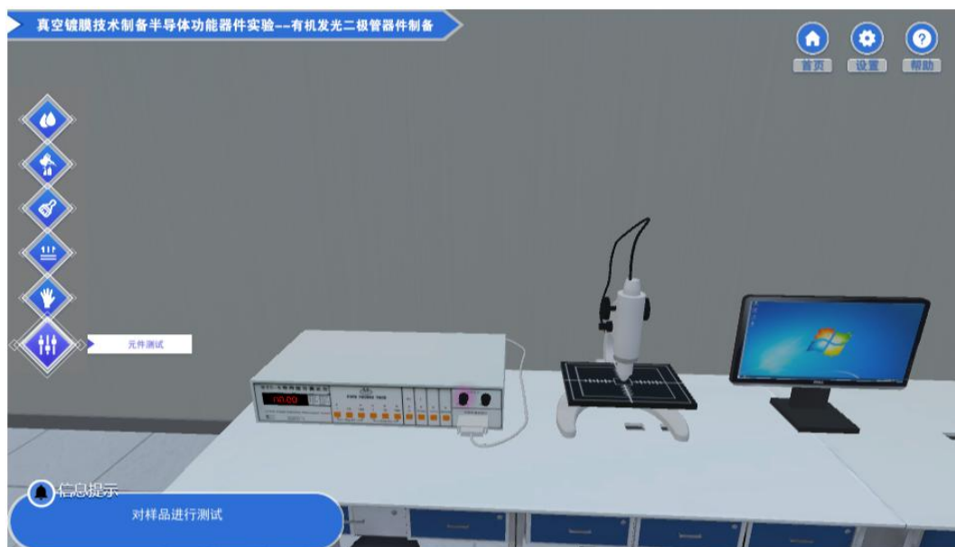
图 28 四探针电阻测试仪测试 ITO 表面电阻
