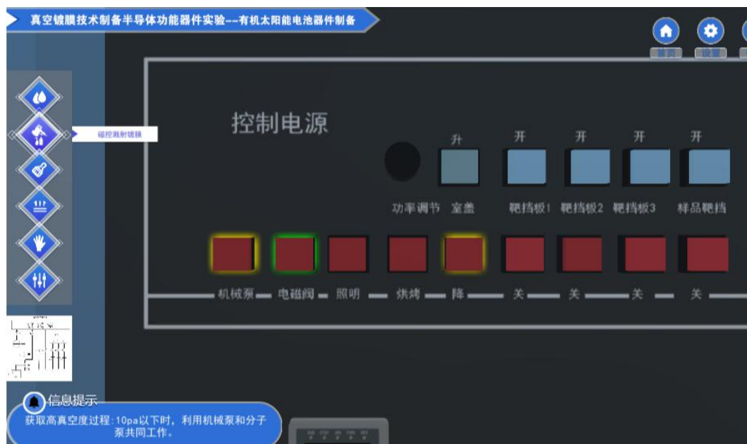
图 11 机械泵与分子泵联合工作获取高真空
